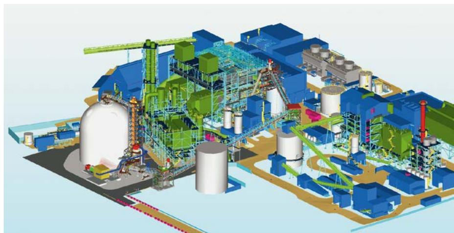
Ces équipements assureront le déchargement et la manutention stockage, le chargement chaudière sur la Centrale ainsi que les opérations de chargement du dôme 2 et des camions sur le port de Jarry.
